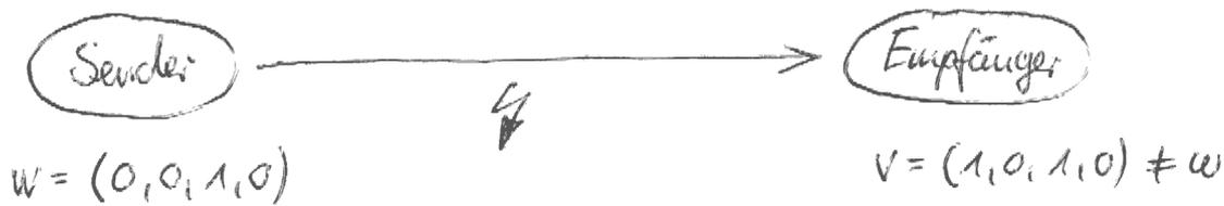
Der Empfänger sucht dann unter allen möglichen Codevektoren  $u$  des verwendeten Codierers denjenigen, der am ehesten zum empfangenen Codevektor  $v$  passt.
